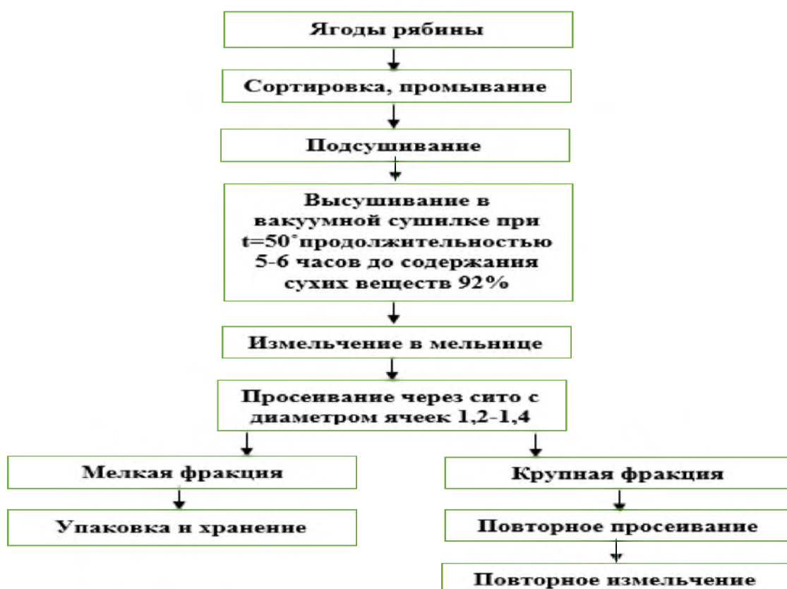
Рисунок 1 - Принципиальная схема технологической линии получения порошка рябины
