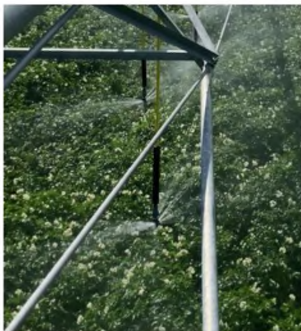
Рисунок 3 – Фрагмент микро струй на кромке рассекателя дождевателя
